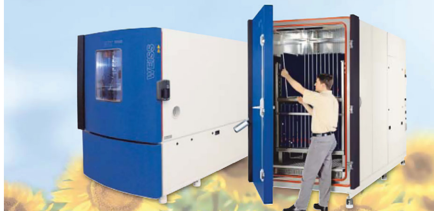
Klimatske komore WK-3100/60 Prostornina 3,1 m 3 Mere preizkusnega prostora Š x D x V: 1100 x 1325 x 2100 mm
